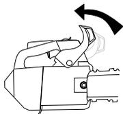
Die Schienenmutter herauserschrauben und den Kupplungsdeckel (Kettenbremse) abnehmen. Den Transportschutz entfernen.
