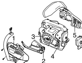
Das Kühlsystem einmal pro Woche mit einer Bürste reinigen, bei schwierigen Verhältnissen öfter. Eine Verschmutzung oder Verstopfung des Kühlsystems führt zur Überhitzung des Gerätes, die Schäden an Zylinder und Kolben zur Folge haben kann.
