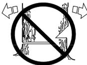
Wir empfehlen eine Führungsschienenlänge zu benutzen, die größer ist als der Stammdurchmesser, so dass Kerb- und Fällschnitt mit einem sog. "einfachen Sägeschnitt" ausgeführt werden können. Siehe Kapitel Technische Daten bzgl. der empfohlenen Führungsschienenlängen für Ihr Motorsägenmodell.
