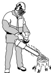
Wenn die Sägekettenschmierung nicht funktioniert:
