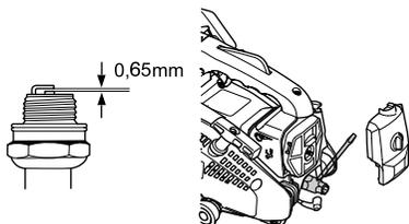
Hinweis! Stets den vom Hersteller empfohlenen Zündkerzentyp verwenden! Eine ungeeignete Zündkerze kann Kolben und Zylinder zerstören. Dafür sorgen, dass die Zündkerze eine sog. Funkenstörung hat.
