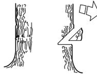
Die Schnitttiefe der Kerbe soll etwa 1/4 des Stammdurchmessers und der Winkel zwischen dem oberen und unteren Schnitt mindestens 45° betragen.
