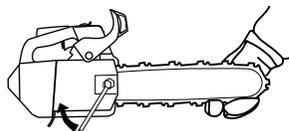
An einer neuen Kette muss die Kettenspannung oft kontrolliert werden, bis die Kette eingefahren ist. Die Kettenspannung regelmäßig prüfen. Mit einer richtig gespannten Kette wird eine gute Schnittleistung und eine lange Lebensdauer erzielt.
