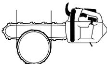
Es gibt Methoden zum Fällen von Bäumen, deren Stammdurchmesser größer ist als die Führungsschienenlänge. Bei solchen Methoden besteht große Gefahr, dass der Rückschlagbereich der Führungsschiene mit einem Gegenstand in Berührung kommt.
