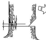
Die Rindenstütze (falls montiert) hinter dem Brechmaß ansetzen. Mit Vollgas sägen und mit der Sägekette/ Führungsschiene langsam in den Baumstamm schneiden. Achten Sie darauf, dass sich der Baumwipfel nicht entgegengesetzt zur Fällrichtung bewegt.
