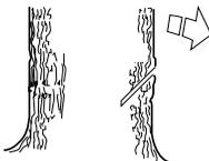
Dann einen Sägeschnitt von unten machen, der genau auf den Sägeschnitt von oben trifft.
