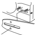
Die Kette durch Drehen der Kettenspannschraube im Uhrzeigersinn (einen Kombischlüssel verwenden) spannen. Die Kette soll gespannt werden, bis sie auf der Schienenunterseite nicht mehr durchhängt. Siehe die Anweisungen unter der Überschrift Spannen der Sägekette.
