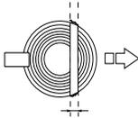
Das Brechmaß funktioniert wie ein Scharnier, das die Richtung des fallenden Baumstammes bestimmt.
