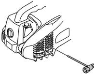
Der Schalldämpfer hat die Aufgabe, den Schallpegel zu dämpfen und die Abgase vom Anwender wegzuleiten. Die Abgase sind heiß und können Funken enthalten, die einen Brand verursachen können, wenn die Abgase auf trockenes und brennbares Material gerichtet werden.
