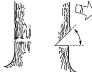
Der Schnittpunkt der beiden Schnitte wird als Kerbschnittlinie bezeichnet. Die Kerbschnittlinie soll exakt horizontal verlaufen und gleichzeitig einen rechten Winkel (90°) zur Fallrichtung bilden.
