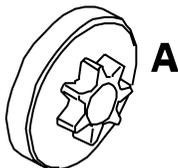
Regelmäßig den Verschleiß des Kettenantriebsrades kontrollieren. Austauschen, wenn das Rad unnormal verschlissen ist. Das Kettenantriebsrad bei jedem Wechsel der Sägekette austauschen.
