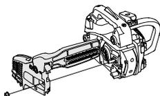
Die Schiene über die Schienenbolzen montieren. Die Schiene in der hintersten Position aufsetzen. Die Kette um das Kettenantriebsrad und in die Schienennut legen. Auf der Oberseite der Schiene beginnen.
