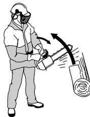
Bei weniger kräftigen Rückschlägen oder wenn sich der Rückschlagbereich in der Nähe des Anwenders befindet, wird die Kettenbremse mit der linken Hand manuell betätigt.
