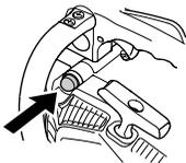
**Zündanlage; Choke:** Den Choke-Regler bis zur zweiten Stellung herausziehen. Das Drosselventil schließt, und der Drosselhebel wird in die Startposition gesetzt.
